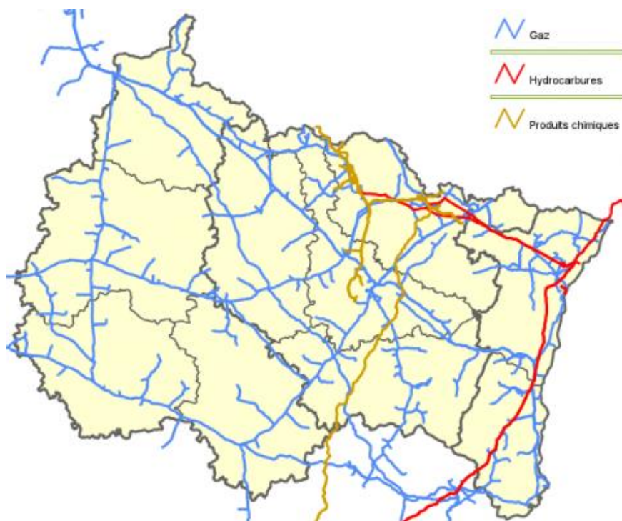
Figure 40 : Réseaux de canalisations de transport de matières dangereuses dans la région Grand Est (DREAL Grand Est)
