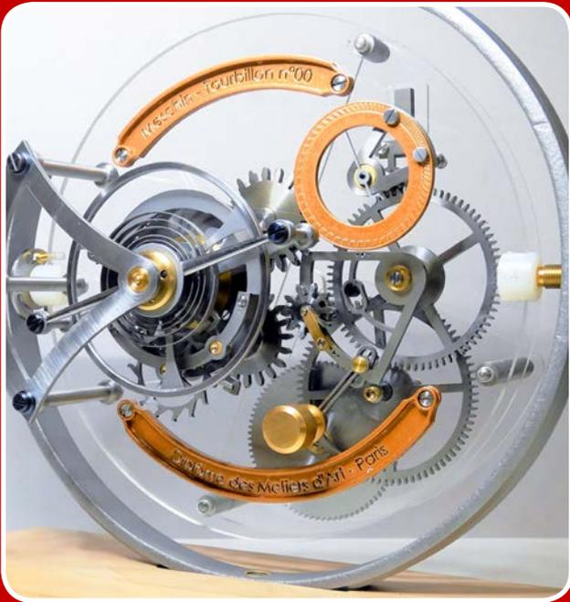
Il s'agit d'un objet pédagogique et didactique, un tourbillon de démonstration qui facilite la compréhension de cette complication, de par sa taille. De plus, un système a été installé permettant de débrayer ce dernier, ainsi l'utilisateur peut montrer à ses élèves, aux clients son fonctionnement.
