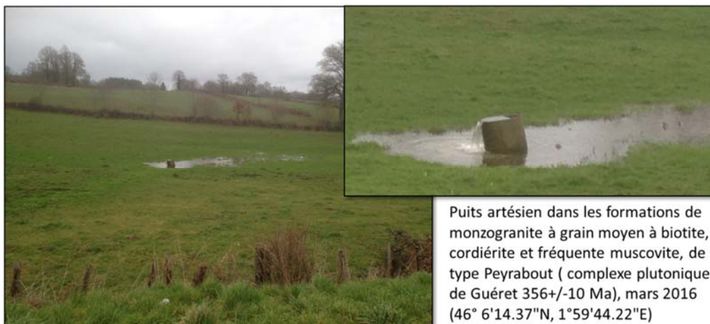
Figure 10 : Phénomène d'artésianisme en limousin, (conductivité des eaux à l'émergence 87 \mu\text{S}/\text{cm} - conductivité des eaux du ruisseau voisin 56 \mu\text{S}/\text{cm} en mars 2016)
