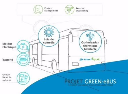
Dans l'objectif d'accompagner le développement de sa nouvelle activité de retrofit véhicule, dont le projet Green-eBUS qui consiste en un kit de motorisation électrique pour bus urbain, Greenmot concevra et fabriquera ses propres packs de batteries électriques. Les packs batterie seront destinés aux besoins des bus urbains, mais aussi à des véhicules industriels et de spécialité.
