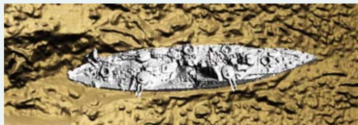
Image numérique du Danton obtenue à partir de données multifaisceaux. Opération Galsi/Fugro.
