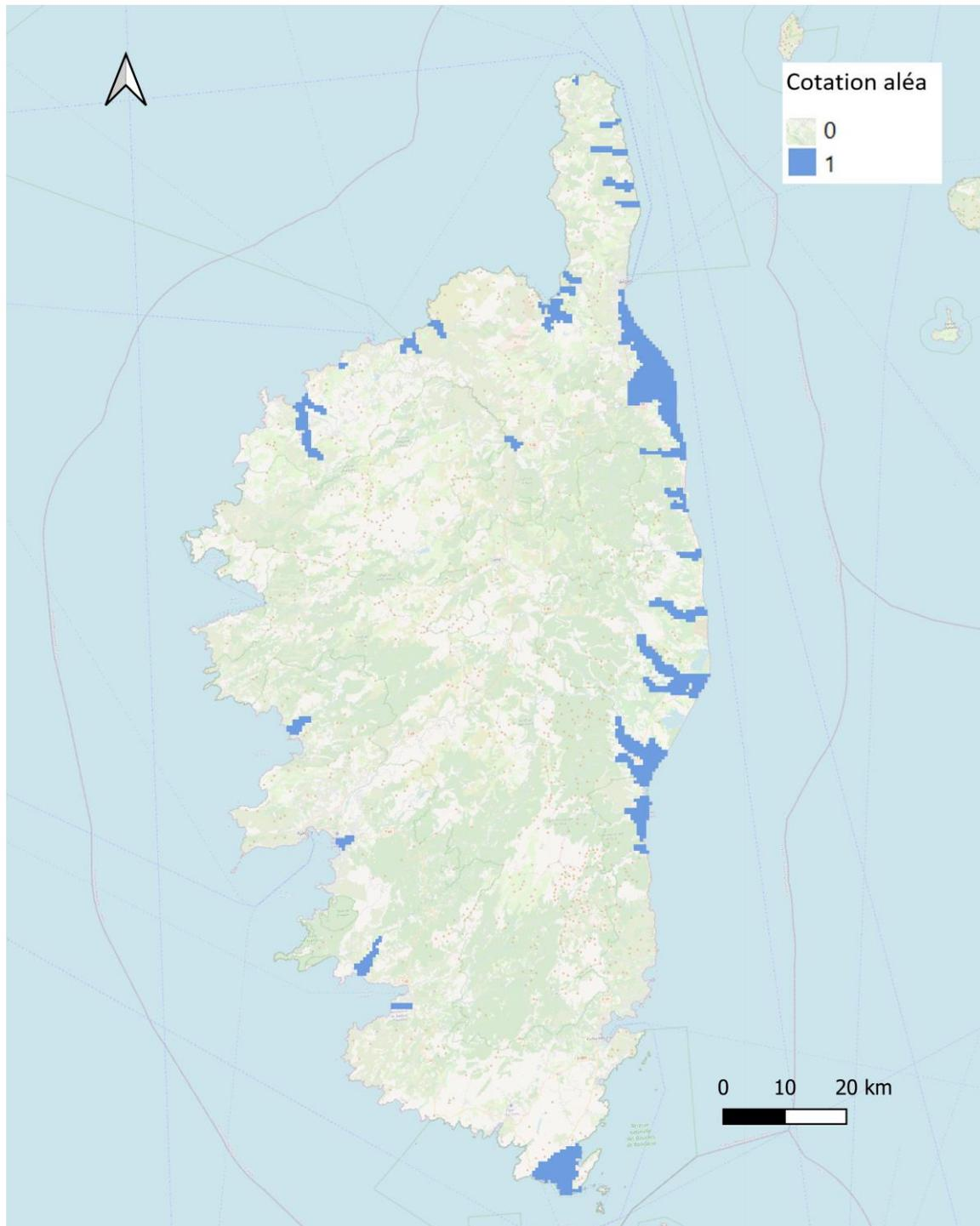
*Illustration 15 : Carte d'aléa du phénomène "Mise en communication des eaux souterraines entre différents aquifères" pour la gamme de profondeur 10 - 50 m, 10 - 100 m et 10 - 200 mètres*
