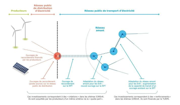
Ainsi, le S3REnR de Grand Est détermine les travaux à réaliser sur les réseaux électriques pour assurer les évolutions nécessaires et la circulation de l'électricité produite par les EnR en distinguant :
