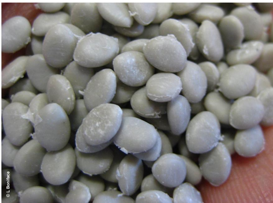
PVB recyclé conditionné sous forme de granules
