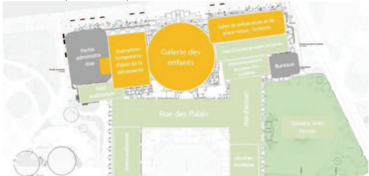
Figure 27 Plan du projet des soubassements du Grand Palais en vert et jaune les zones accessibles au public, en gris les zones tertiaires réservées au personnel
