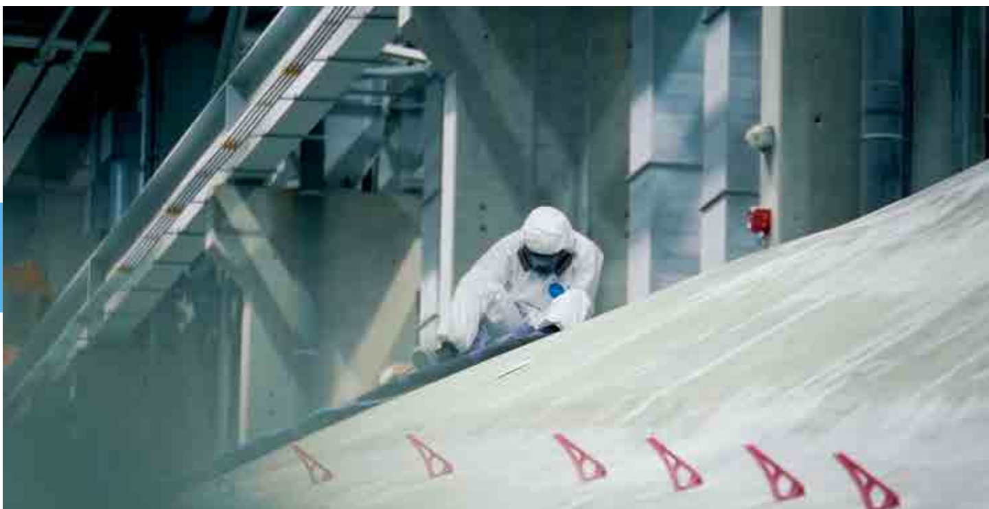
Fabrication de pales d'éoliennes, LM Windpower, Cherbourg.
