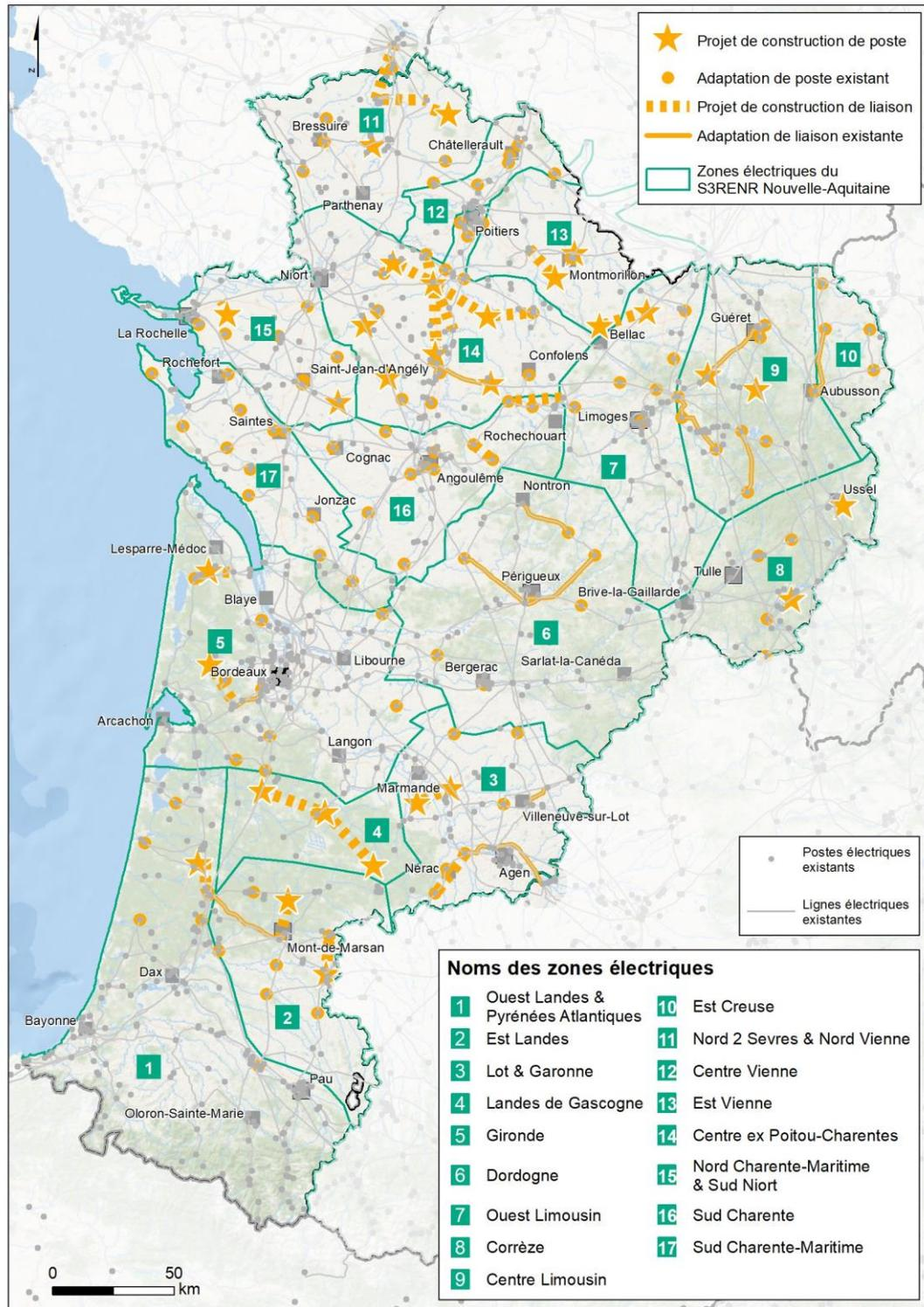
Figure 1: Aménagements envisagés sur le réseau électrique en Nouvelle-Aquitaine
