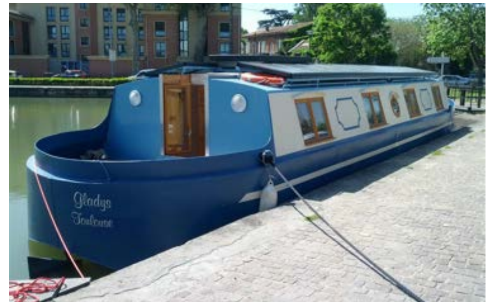
Profil et plan de barque, fin du XVIIIe siècle, Archives municipales de Toulouse Gladys, première péniche du canal du Midi à énergie solaire
